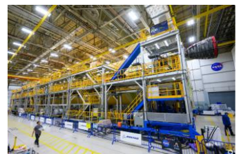
IL PRIMO MOTORE RS-25 INSTALLATO SULLO STADIO CENTRALE DI SLS PRESSO IL MAF (NASA).
