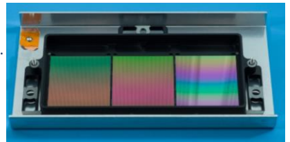
Filtri per l'analisi spettroscopica di SPHEREx (NASA/JPL-Caltech)
