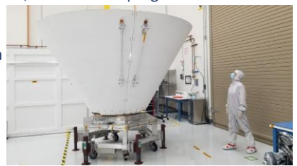
Lo scudo a cono per la protezione termica del telescopio SPHEREx (NASA/JPL-Caltech)
