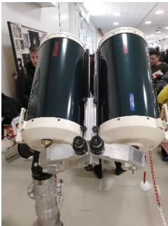
Binoscopio formato da due Vixen VMC 260L
