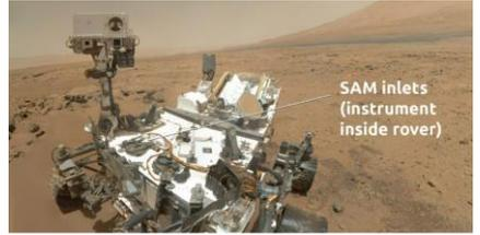
Il rover Curiosity e il suo strumento SAM (Sample Analysis at Mars (NASA/JPL/Caltech))
