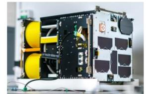
ACS3, in fase di assemblaggio e test. La navicella spaziale ACS3 completa misura circa 23 centimetri x 23 centimetri x 34 centimetri. (AST&Difesa LLC/NASA)
