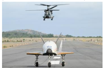
Lo spaziolano Pushpack in fase di atterraggio dopo il rilascio dell'elicottero militare (ISRO)
