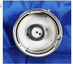
Parte terminale di uno dei giroscopi di Hubble, in cui si notano i sottilissimi cavi noti flex leads (NASA)
