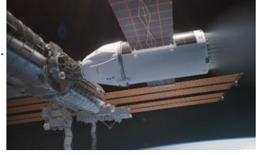
Nell'illustrazione il veicolo ISS dv di SpaceX con i motori Draco accesi per spingere la ISS verso la sua fine (SpaceX)
