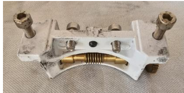
Passo 15: Smontiamo le 4 viti del gruppo di trasmissione con la vite senza fine
