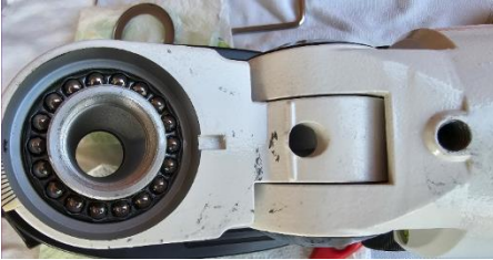
Passo 12: Possiamo togliere i due cuscinetti di entrambi gli assi. A sinistra il cuscinetto dell'asse di declinazione e a sinistra il cuscinetto dell'asse di ascensione retta
