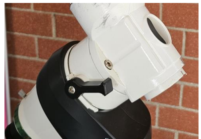
Passo 8: Smontiamo la sede dell'asse di declinazione svitando le due viti
