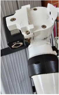
Passo 1: Installiamo la montatura sul treppiede
