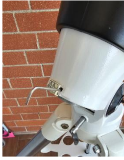
Passo 10: Svitiamo la vite di bloccaggio della ghiera dell'asse dell'ascensione retta
