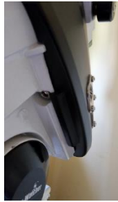
Passo 13: Smontiamo il carter per poter accedere al gruppo della trasmissione dell'asse di ascensione retta
