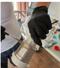
Passo 16: Con il pennello passiamo a cospargere di grasso al litio tutte quelle parti che sono in movimento.
