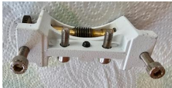
Passo 4: Smontiamo le 4 viti del gruppo di trasmissione con la vite senza fine
