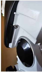
Passo 13: Smontiamo il carter per poter accedere al gruppo della trasmissione dell'asse di ascensione retta
