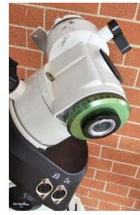
Passo 5: Dobbiamo sfilare l'asse di declinazione e per farlo bisogna svitare la ghiera
