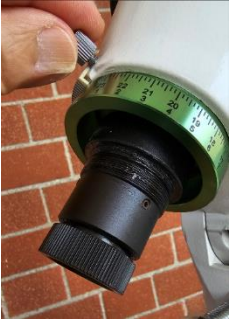
Passo 9: Smontiamo il cannocchiale polare e la ghiera graduata
