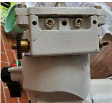
Passo 4: Smontiamo le 4 viti del gruppo di trasmissione con la vite senza fine
