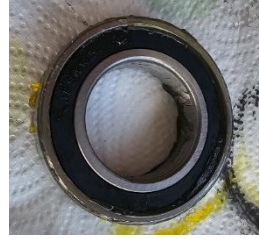
Passo 12: Possiamo togliere i due cuscinetti di entrambi gli assi. A sinistra il cuscinetto dell'asse di declinazione e a sinistra il cuscinetto dell'asse di ascensione retta
