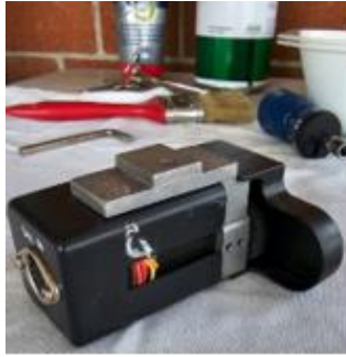
Passo 2: Smontiamo il motore dell'asse di declinazione
