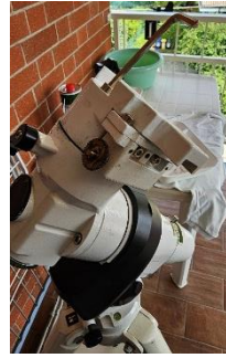
Passo 3: Smontiamo l'attacco a coda di rondine svitando le due viti con testa esagonale incassata.
