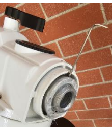
Passo 6: Smontiamo la vite di bloccaggio della ghiera
