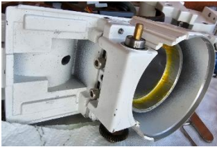
Passo 15: Smontiamo le 4 viti del gruppo di trasmissione con la vite senza fine
