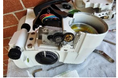
Passo 14: Smontiamo il gruppo motore dell'asse dell'ascensione retta
