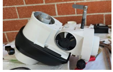
Passo 11: Possiamo continuare le operazioni togliendo la testa della montatura dal treppiede.
